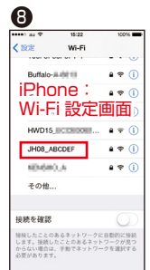
8 iPhone の「設定」、「Wi-Fi」を開きます。一覧から JH08_ で始まる本製品の SSID を探します。例：JH08_ABCDEF
