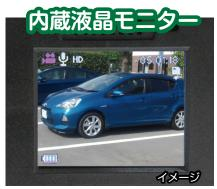
2 インチカラー液晶画面内蔵。本体で 動画・写真再生、削除、設定ができます。
